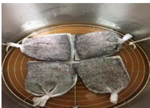
ภาพที่ 1 การบรรจุกล้าเชื้อน้ำส้มสายชูในถุงตาข่ายและวางบนตะแกรงที่ผิวน้ำหมัก (medium)
