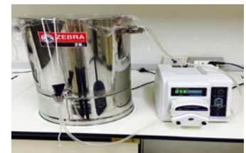
ภาพที่ 3 รูปแบบการติดตั้งอุปกรณ์การหมักน้ำส้มสายชูด้วยระบบไหลวน
